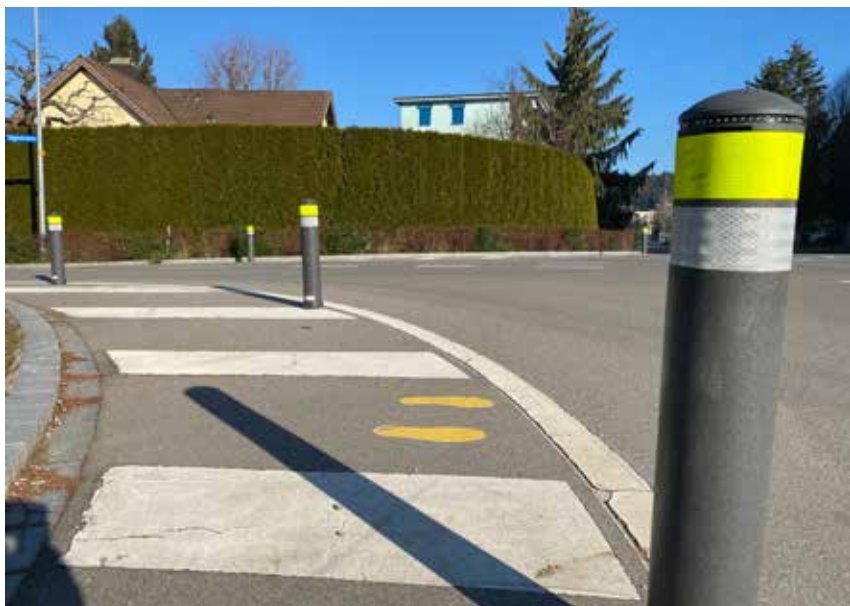
Poller und eine neue Markierung sollen die Sicherheit für Fussgänger an der Kreuzung Säge-/Wiesentalstrasse erhöhen.
